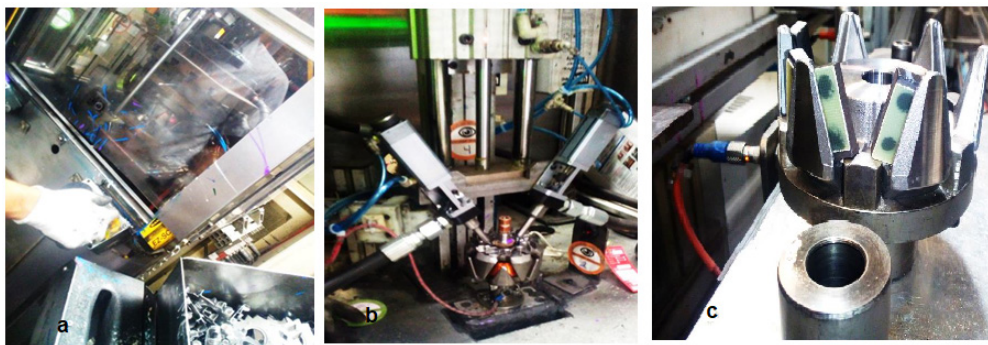
Figura 3. a) Instalación de ventilador, b) Suministro de resina en terminales y c) Inserción de magnetos.
