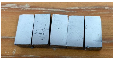
Figura 3. Probetas de acero AISI 1020 mecanizadas y pulidas para pruebas de electrodeposición.
