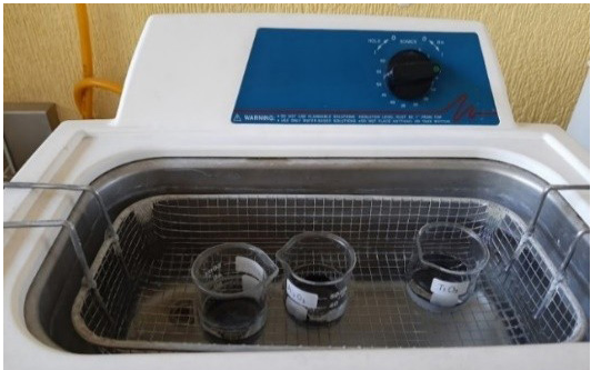
Figura 2. Preparación de nanocompuestos utilizando el proceso de baño ultrasónico.
