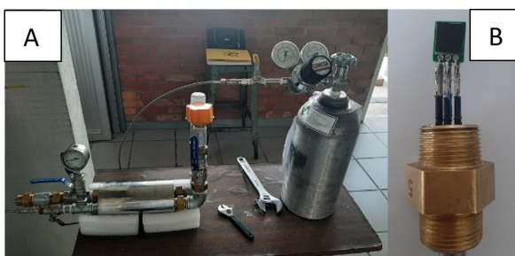
Figura 14. (A) Cámara de gas para pruebas de eficiencia, (B) Conexión del sensor.
