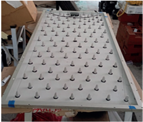
Figura 3. Obstrucciones en la superficie posterior del panel.
