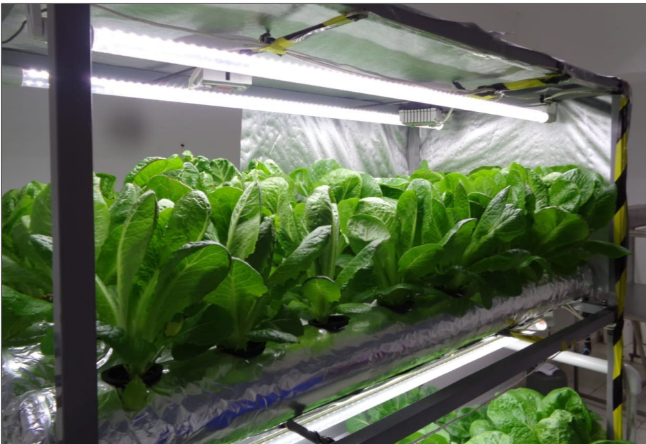
Figura 5. Cultivo de lechuga ( Lactuca sativa L. ) a 60 días después del trasplante producida bajo el prototipo a una intensidad de luz de 5000 a 12200lux.
