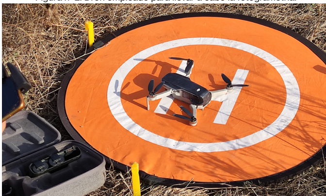
Figura nº2. Dron empleado para llevar a cabo la fotogrametría.
