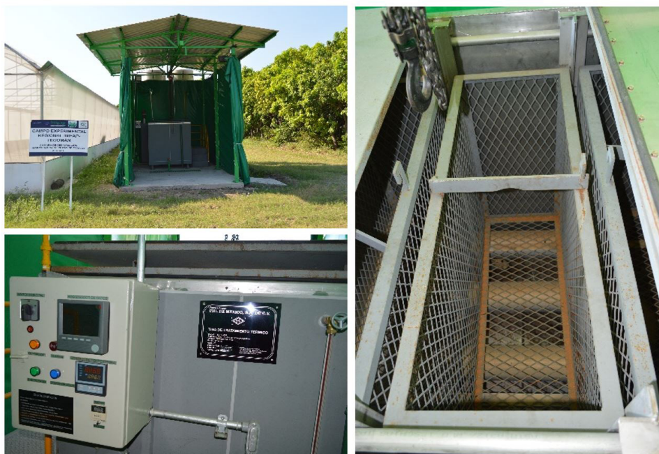
Figura 22. Cámara hidrotérmica automatizada para la desinfección de semilla-estaca de caña de azúcar.
