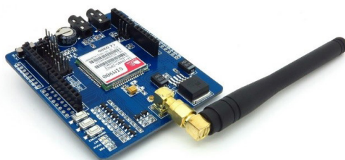
Figura 16. Módulo GSM GPRS SIM900. Elaboración propia, 2019.
