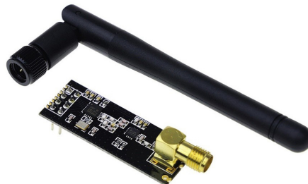
Figura 10. Módulo RF Tx/Rx. Elaboración propia, 2019.
