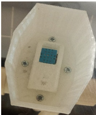
Figura 5. Encapsulados PETG impresos en 3D. Elaboración propia, 2019.
