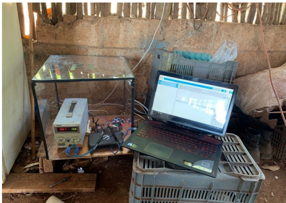
Figura 21. Repetidor RF y enlace GSM. Elaboración propia, 2019.
