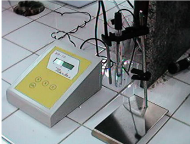
Figura 4: Aparelho MB-10 MARTE para leituras Diretas de pH.
