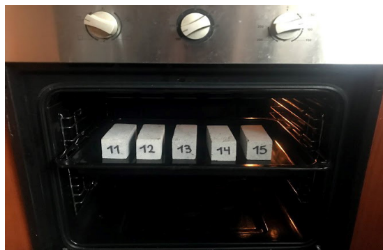
Figura 2. Probetas de roca en horno para secado.
