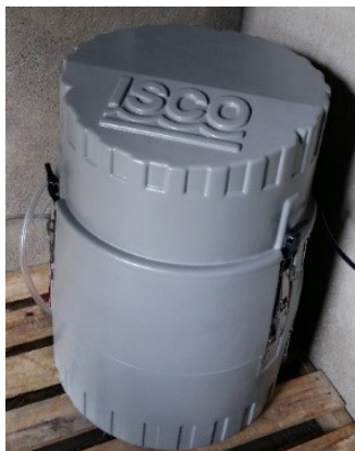
Figura 3. Amostrador automático de recolha de amostras de água para análise laboratorial, marca Teledyne ISCO, modelo 6712.
