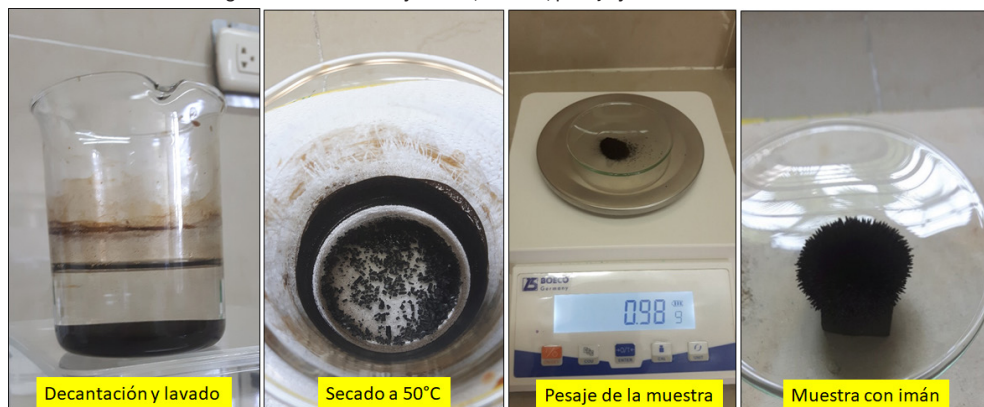
Figura 3. Decantación y lavado, secado, pesaje y muestra con imán.
