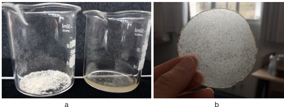
Figura 3. Carboximetilcelulose (CMC) produzido a partir do resíduo do milho. a) CMC sintetizada em forma de pó antes da polimerização. b) CMC polimerizado.
