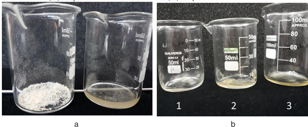
Figura 4. a) Teste de gelificação do CMC produzido em água. b) Testes em CMC comercial (b1) solução alcalina; em CMC sintetizado (b2) solução alcalina e em CMC sintetizado (b3) solução ácida.
