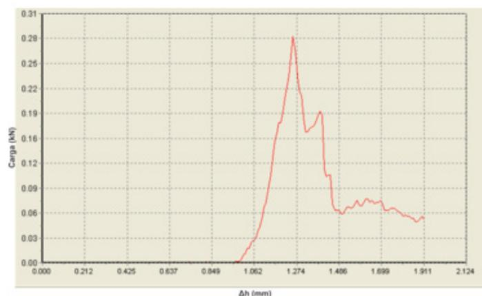
Com exceção da condição de 9% de cal, 1160°C por 30min, todas as outras amostras apresentaram valores de resistência mecânica superiores, se comparadas às pelotas queimadas durante 10min. Em geral as pelotas queimadas durante 30min apresentaram uma resistência mecânica 1,5 vezes maior que o outro intervalo de tempo.
