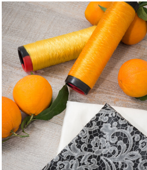
Figura 5 - Celulose cítrica transformada em fibra têxtil.
