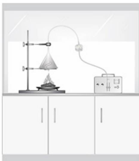
Figura 1. Colecta de gases emitidos durante la combustión de madera para la determinación del contenido de HAP de la biomasa utilizada como fuente de energía en la comunidad La Marcela, Miquihuana, Tamaulipas.
