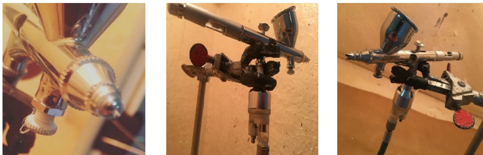
Figura 4. Fotografia digital de aerógrafo comercial; (a) detalhes do bico, (b) estrutura e (c) detalhes do reservatório.
