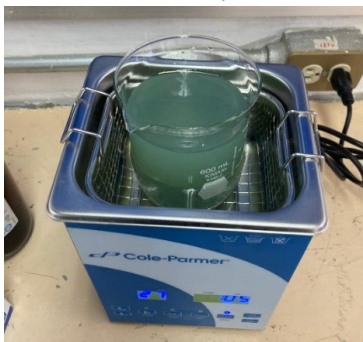
Figura 2. Baño electrolítico con nanopartículas de cromo CrNP's.
