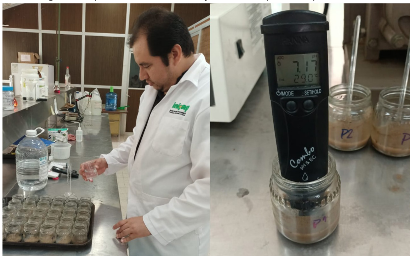
Figura 3. Preparación de las muestras y medición de pH con un potenciómetro.
