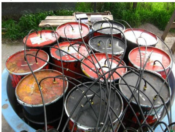
Figura 2. Tambores de ensayos Batch junto con sus gasómetros.
