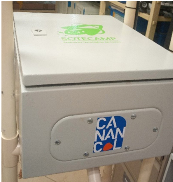
Figura 12. Encapsulado final de circuito en sistema in situ. Elaboración propia, 2019.
