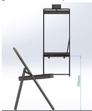
Figura 1. Dimensiones del piso a la base.
