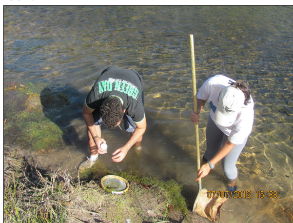
Figura 2. Coleta de bentos em sedimento de rio, com uso de peneira e rede tipo D. Chapada dos Veadeiros, GO. Foto: Maria Júlia Martins Silva.
