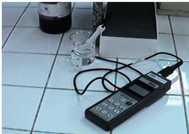
Figura 5: Aparelho HD NC 06 ONDA de leitura Direta da condutividade elétrica para as amostras de água residuária.
