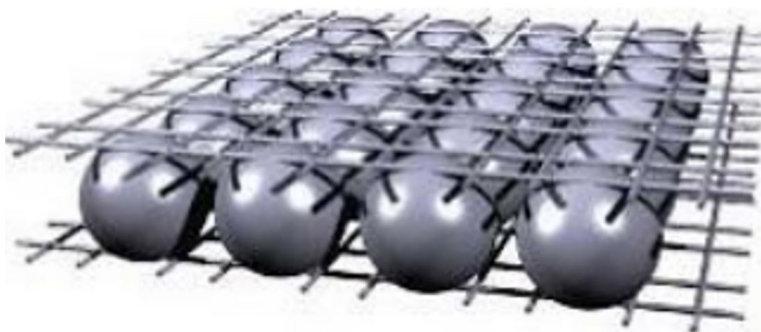
Figura 2 - Sistema de módulo reforçado (BUBBLEDECK BRASIL, 2019).
