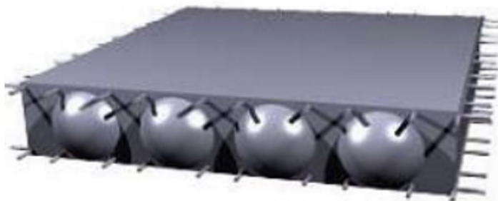
Figura 4 - Painéis acabados (BUBBLEDECK BRASIL, 2019).
