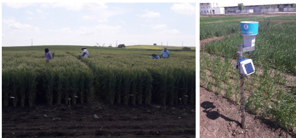
Figura 1. Controle das características ecofisiológicas nas parcelas do regime hídrico R1, e sonda capacitiva instalada na mesma parcela.
