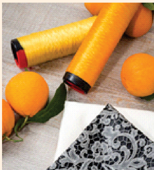
Figura 3 - Celulose cítrica transformada em fibra têxtil. Fonte: Orange Fiber (2015).
