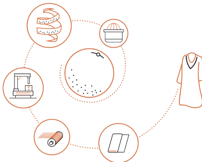
Figura 4 - Etapas de produção da seda a partir de fibras cítricas.
